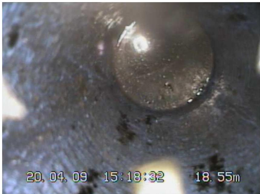
Abb. 11, Schmutzablagerungen und Ölfilm in der Sonde Gamma
