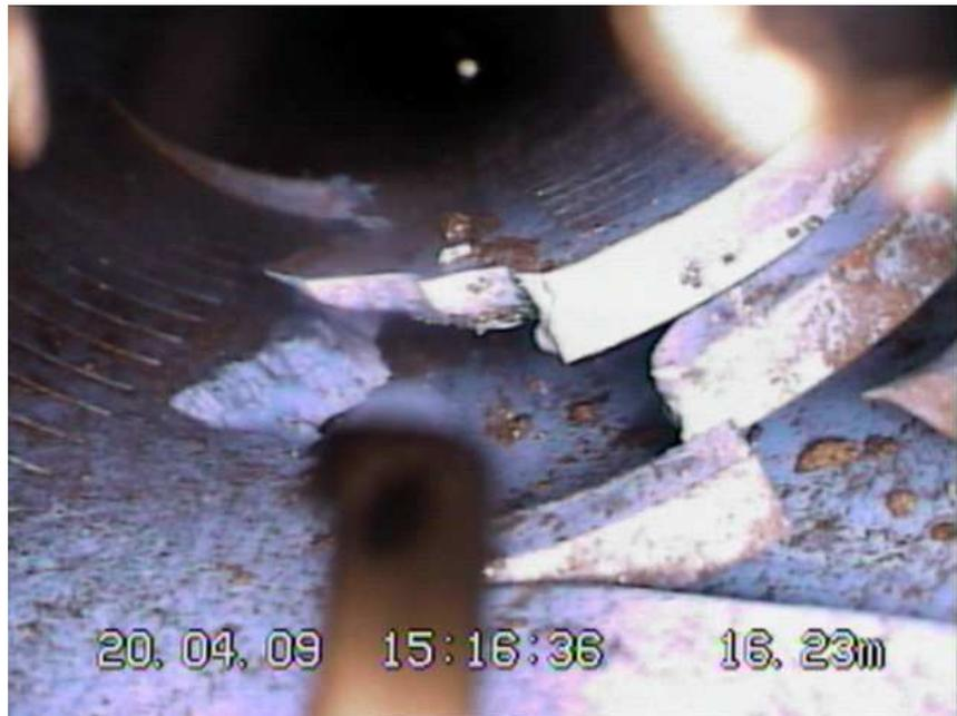
Abb. 10, Beschädigung der Mantelfläche des Filterrohres in der Sonde Gamma
