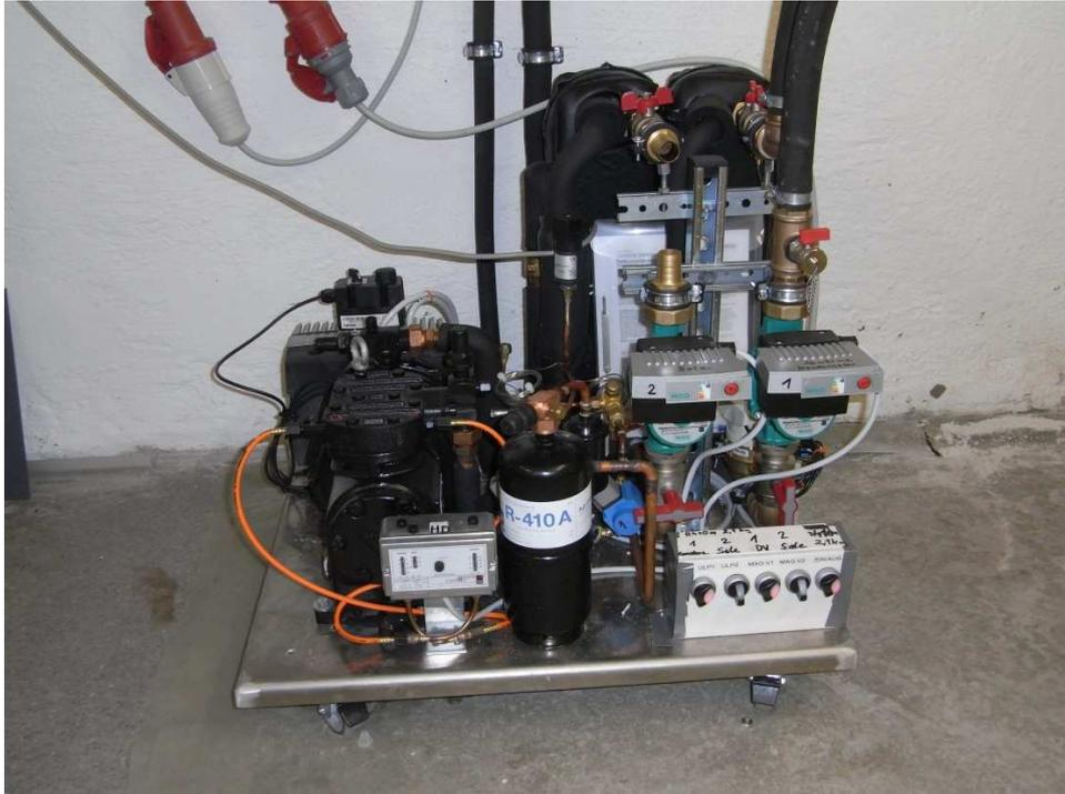
Abb.: 43, Versuchsanlage für DV und Sole mit frequenzgesteuertem Verdichter (2,4 – 6 KW)
