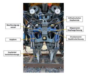
Das oben dargestellte Bild zeigt das patentierte vollhydraulische System7 Weichenstopfaggregat mit kraftflussoptimierter Stopfarmkonstruktion, symmetrischen Pickelhaltern und Sensorik.
